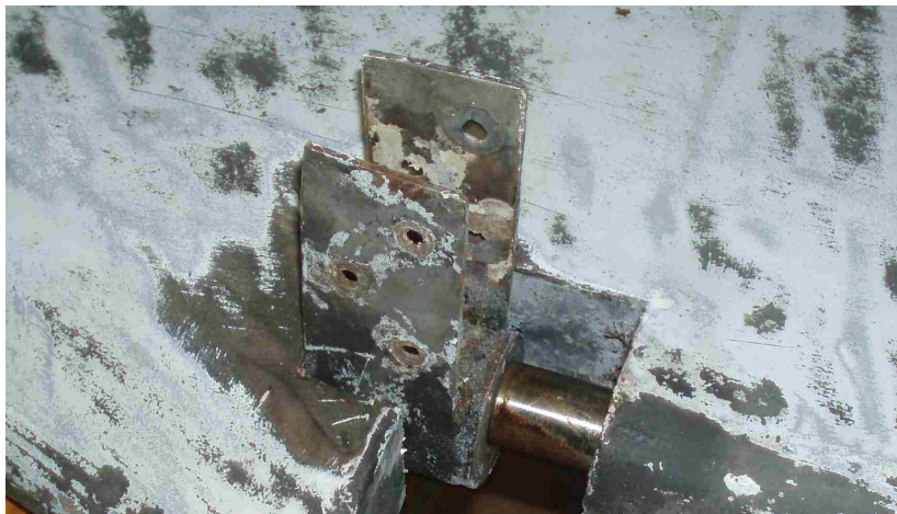
Tourner la patte de 90° et utiliser l'espace libre pour la désengager de la mèche
