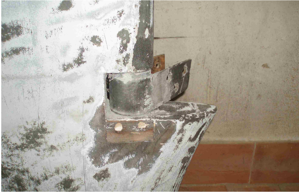
Après ponçage, on distingue la cale amovible et deux des quatre vis de fixation.
