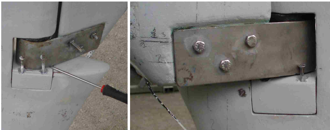
Vissage après mise en place (ne pas coller pour pouvoir l'enlever si besoin).
