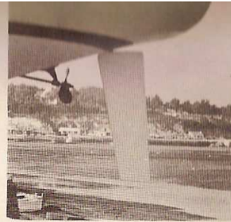
Pour placer la chaise d'arbre d'hélice, il a fallu supprimer l'aile qui précède le safran dans la version hors bord. Remarquez la concavité de la coulée.
