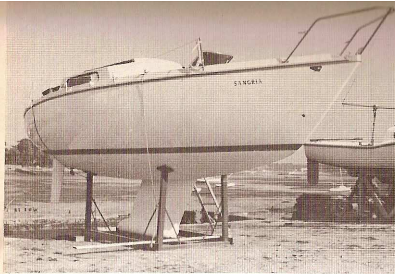
Pour placer la chaise d'arbre d'hélice, il a fallu supprimer l'aile qui précède le safran dans la version hors bord. Remarquez la concavité de la coulée.
